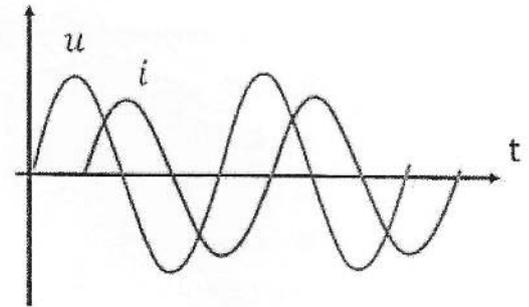
Q9. Soit un condensateur de capacité  $C$ . On note  $u(t)$ , la tension à ses bornes et  $i(t)$ , le courant qui le traverse. On utilise la convention récepteur pour flécher courant et tension. Choisir la relation correcte :
