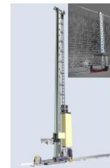
Transstockeur s'élevant jusqu'à 20m de hauteur
